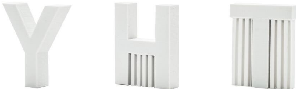
Figuur 5 Support voorbeelden bij overhangende elementen
