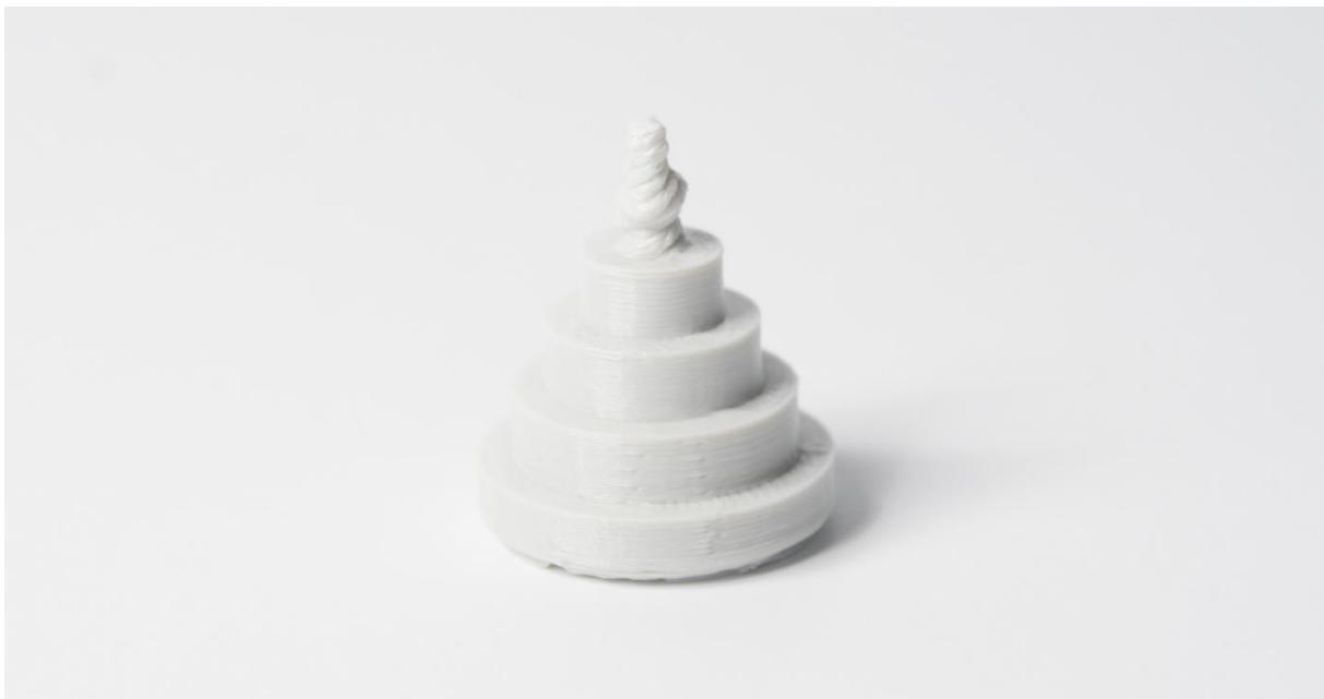
Figuur 8 Print van verticale pinnen met afnemende diameter (van 25 tot 5 mm) die illustreert dat de bovenste diameter van de print te klein wordt om nauwkeurig af te drukken.
